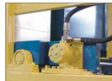
hydraulische kraftvolle Antriebe – CETOP Norm, schneller Rückwärtsgang heavy duty hydraulic drives – CETOP standard, fast reversing gear
